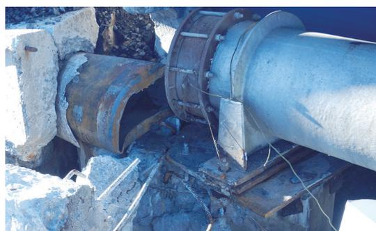
地震により破断した水道管 (令和6年能登半島地震)
